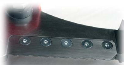
Gezahnte Messer für optimalen Halt
